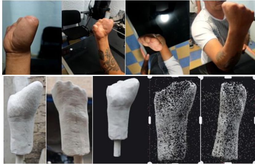
Fig. 2. Toma de Molde y Escaneo tridimensional del modelo, conservando sus condiciones anatómicas del paciente.
