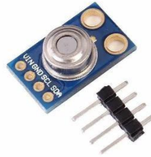
Fig. 8. Sensor infrarrojo MLX90614 empleado para la medición de temperatura corporal sin contacto.
