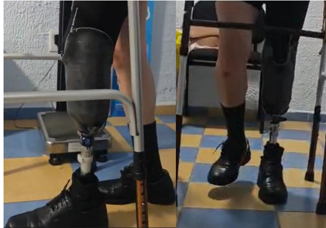
Fig. 7. Paciente 2 en prueba de marcha con socket mediante vacío.
