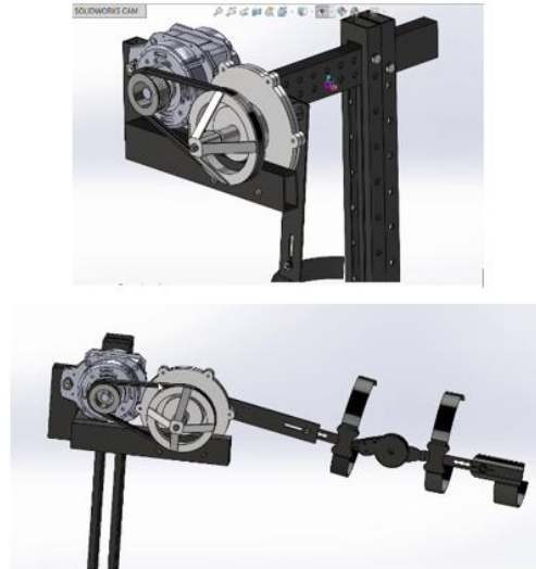
Fig. 1. Sistema rehabilitador de hombro y codo para recuperación funcional
