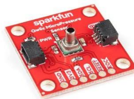
Fig. 9. Sensor SparkFun Qwiic MicroPressure utilizado para la medición de presión arterial mediante brazalete inflable.
